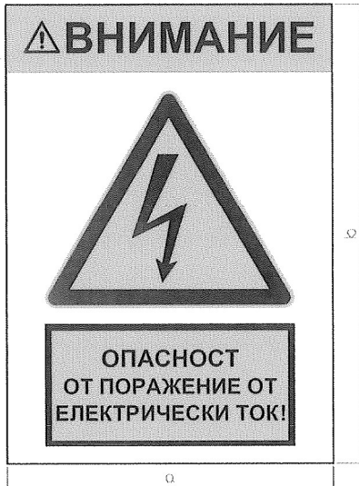
Фигура 5 - Табела „Внимание! Опасност от поражение от електрически ток!“
